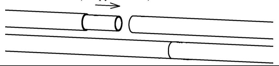
5. При соединении между собой соседних секций снегозадержателя обжатые концы одной перекладины вставляются в свободные концы другой перекладины, и фиксируются болтами.
